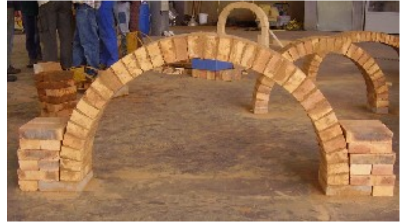
3- les forces empruntent un chemin de forme chaînette hors duquel on peut enlever les briques. En dernier, on retire les charges des reins.
