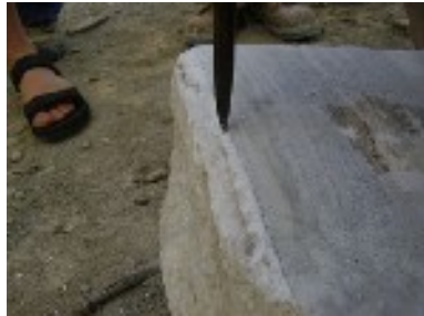
Réalisation d'une ciselure :
