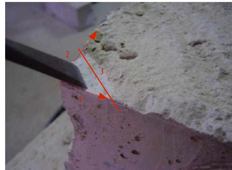
La finition des faces se fait en triangle, on suit l'arête des deux côtés et on taille à plat entre les 2 arêtes.
