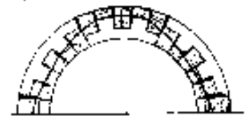
3- les forces empruntent un chemin de forme chaînette hors duquel on peut enlever les briques. En dernier, on retire les charges des reins.
