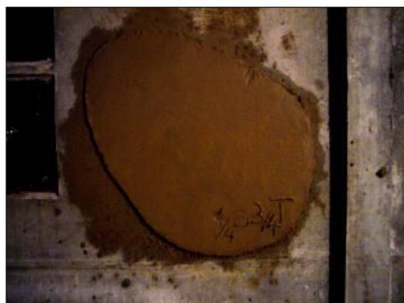
Essais de dosage en sable d'enduits en terre après tamisage de la terre à pisé locale.
