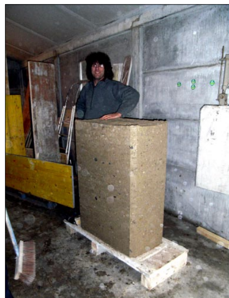
Décoffrage du premier échantillon et coffrage du second, en arrière-plan, avec stabilisation à 7% de chaux.
